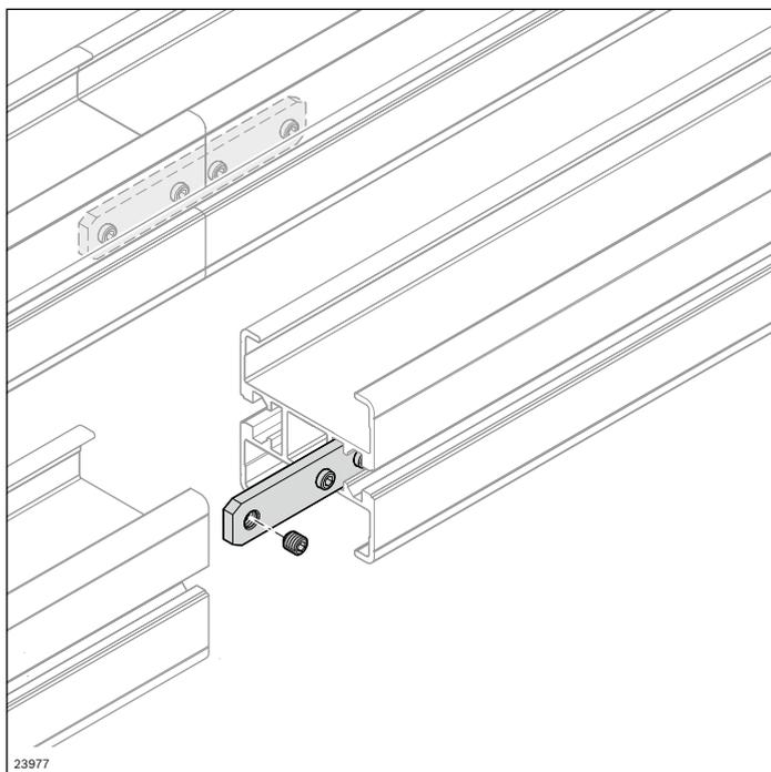
La jonction face avant des profilés de section s'effectue avec deux jonctions de profilés La jonction de profilés est fixée dans la rainure intérieure afin que la rainure extérieure soit disponible pour les montages additionnels de tout type.
