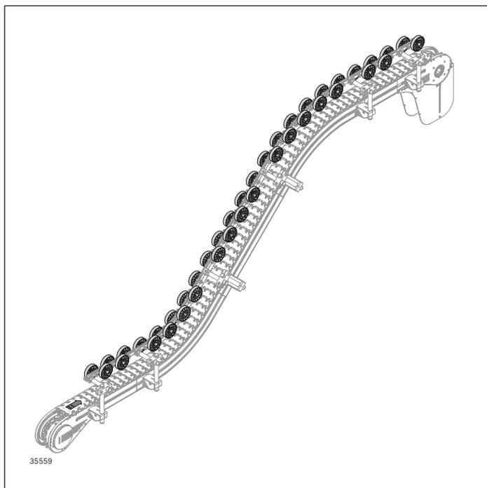
Permet le transport vertical économique de produits légers. La pression d'appui sur la chaîne de convoyage plate augmente le frottement et permet ainsi un transport sûr dans la section verticale.
