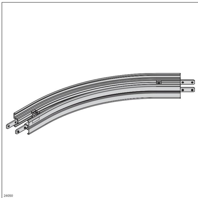
La courbe de glissement sert au changement de direction horizontal de la chaîne, lorsque l'espace de montage ne suffit pas pour une courbe à disque ou si les vitesses ou les dimensions du produit ne permettent pas le transport par la courbe à disque. La courbe de glissement est utilisée afin de réduire le niveau sonore en cas de vitesses élevées ou lors du transport de produits longs dans le convoyeur à serrage. La force de traction de la chaîne augmente par le frottement produit.
